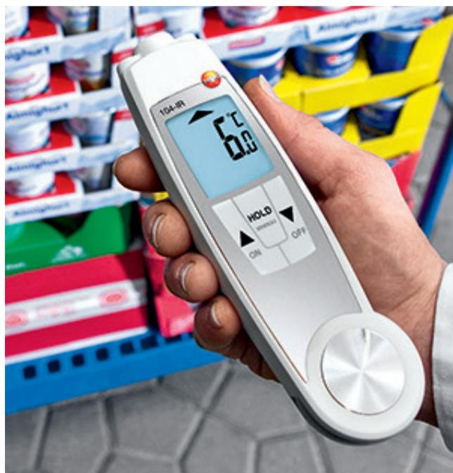
Controllo della temperatura nel reparto ingresso merci con lo strumento testo 104-IR
