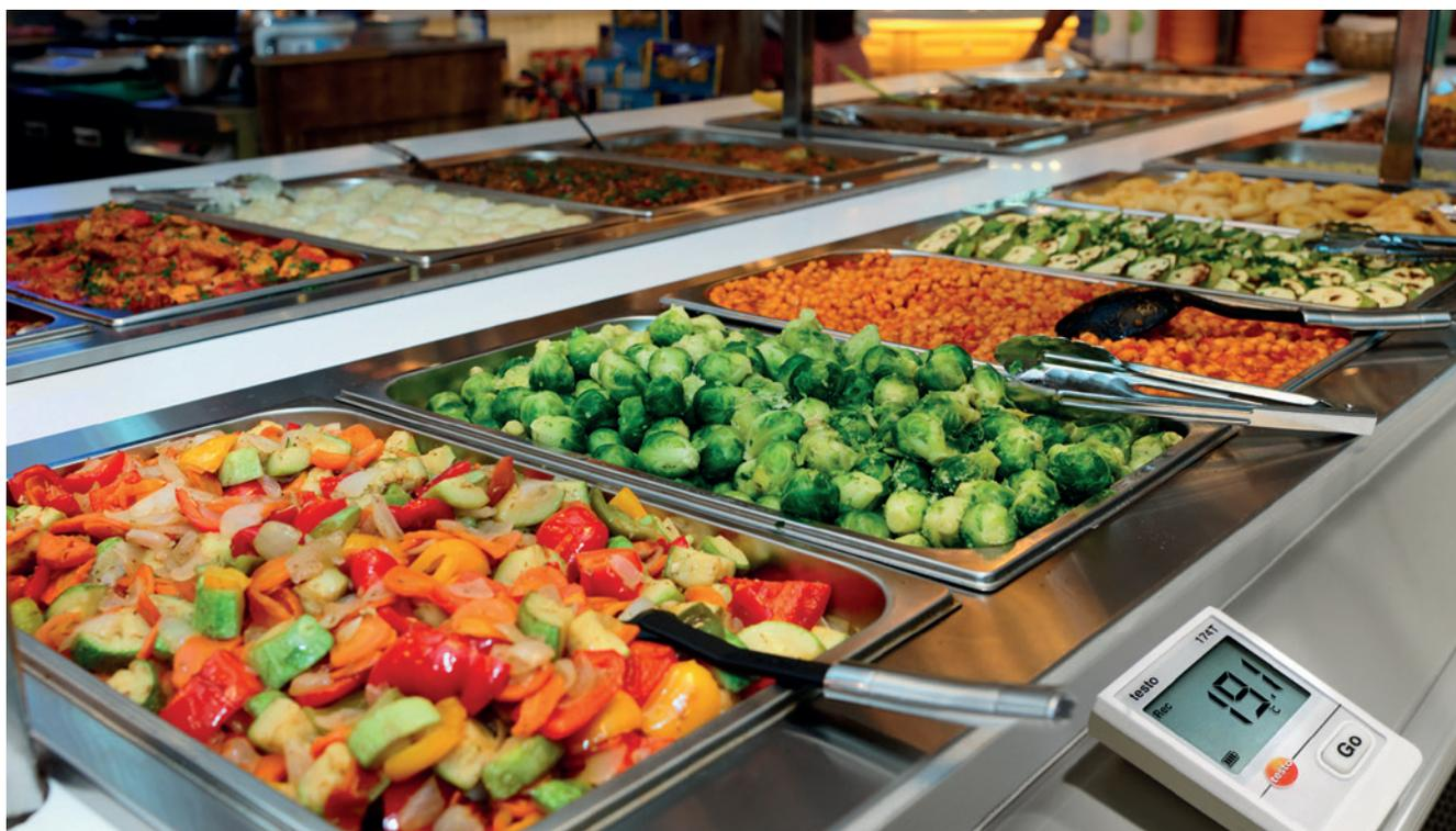
Monitoraggio delle temperature durante la distribuzione dei pasti con lo strumento testo 174 T
