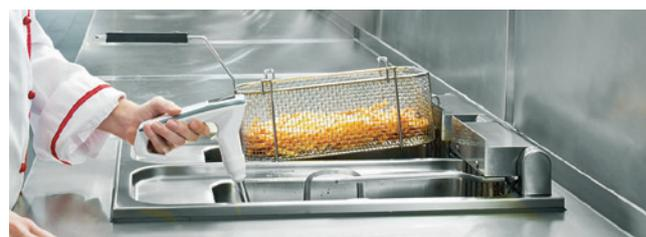
Misura della qualità dell'olio di frittura con lo strumento testo 270
